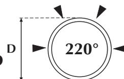
**CAMPI D'IMPIEGO:** TWIN DREN in barre da 6 m. è fornito nel colore nero, classe di rigidità SN 4 e SN 8 con fessurazioni a 220° è stato realizzato per la soluzione del drenaggio di strade, aeroporti, settore edilizio, consolidamento terreni, campi sportivi e strutture similari. Questo tubo presenta una base liscia che oppone una minima resistenza allo scorrimento dell'acqua, garantendo così alla funzionalità dell'impianto.
